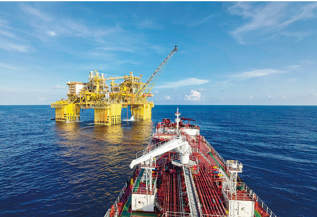
穿梭油轮与“深海一号”能源站对接输油(资料照片)。
